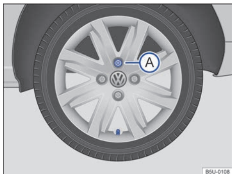
Fig. 160 Cambio de rueda: secuencia de remoción de los tornillos de la rueda.
