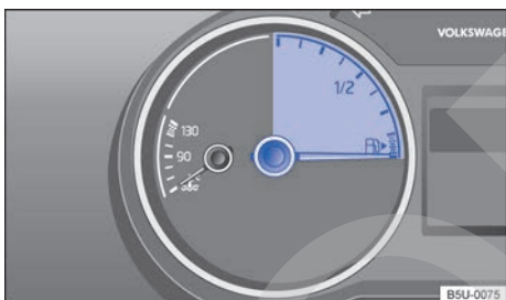
Fig. 121 En el panel de instrumentos: indicador de la reserva de combustible (variante 1).
