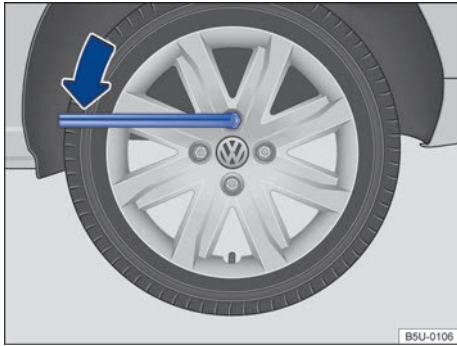
Fig. 158 Cambio de rueda: aflojar los tornillos de la rueda.
