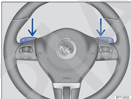
Fig. 105 Volante con dos selectores basculantes para cambio de marcha en el modo manual.
