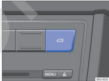
Fig. 32 En la parte superior de la consola central: tecla de apertura de la tapa del maletero.
