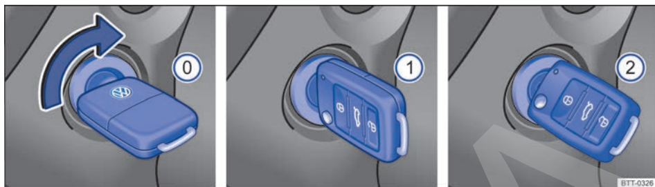
Fig. 97 Al lado del volante, a la derecha: posiciones de la llave del vehículo en el cilindro de encendido.
