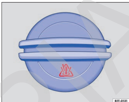
Fig. 131 En el compartimento del motor: tapa del tanque del líquido refrigerante de motor.
