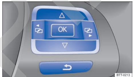
Fig. 17 Lado derecho del volante multifunción: teclas de comando.
