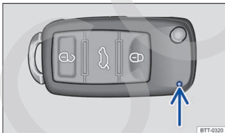
Fig. 24 Luz de control de la llave del vehículo con control remoto.
