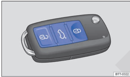
Fig. 28 Teclas en la llave del vehículo con control remoto.
