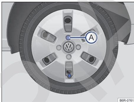
Fig. 149 Retire el tapacubos integral.
