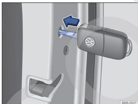
Fig. 57 Cierre de emergencia del vehículo con la llave del vehículo.
