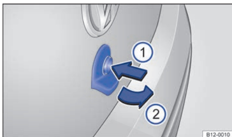
Fig. 59 Abrir la tapa trasera por afuera.
