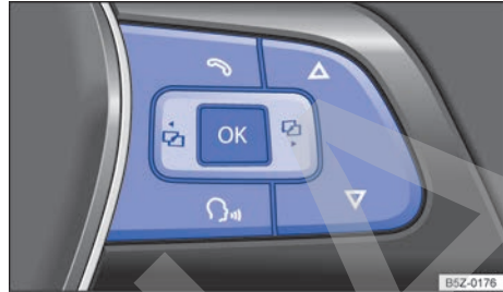
Fig. 42 Lado derecho del volante multifunción: teclas de mando de los menús del panel de instrumentos.
