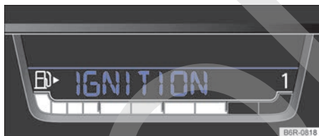
Fig. 38 En el display del instrumento combinado: indicador de encendido activado.
