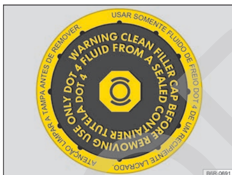
Fig. 139 En el compartimento del motor: tapón de cierre del depósito del líquido de frenos (variante 1).
