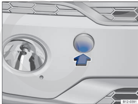
Fig. 130 En el parachoques delantero a la derecha: suelte y desmonte la cubierta.
