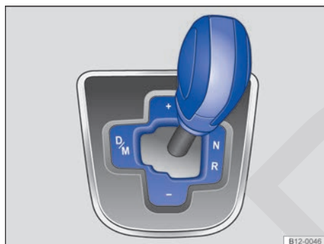
Fig. 87 Palanca selectora de la transmisión automatizada.
