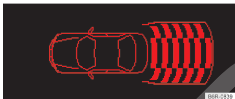
Fig. 92 Presentación del display del control de distancia de estacionamiento en la radio.
