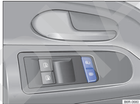
Fig. 52 En la puerta del conductor: tecla del cierre centralizado.
