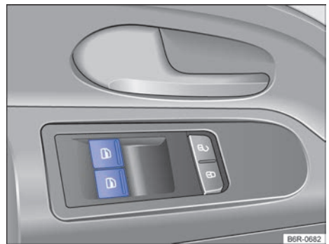
Fig. 62 En la puerta del conductor: teclas de los levanta vidrios eléctricos delanteros.
