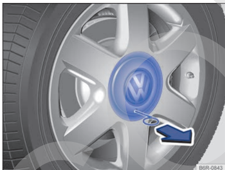
Fig. 148 Retirar el cubrerrueda de la rueda de aleación ligera.
