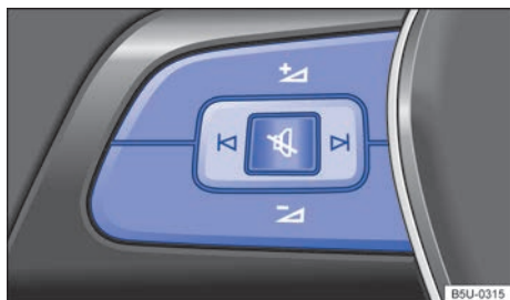
Fig. 43 Lado izquierdo del volante multifunción: teclas de comando.
