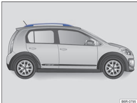
Fig. 109 Soportes longitudinales del maleteros de techo (ambos lados).
