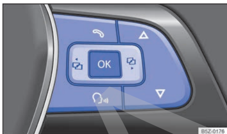
Fig. 44 Lado derecho del volante multifunción: teclas de comando.
