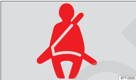
Fig. 3 Luz de advertencia en el instrumento combinado.
