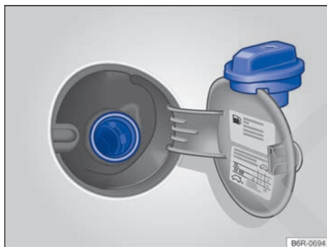
Fig. 110 Portezuela del depósito de combustible abierta con el tapón de cierre del depósito de combustible colgado.
