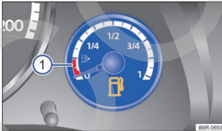
Fig. 40 En el instrumento combinado: indicador del nivel de combustible (variante 2).
