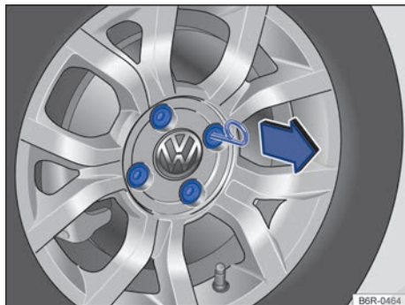
Fig. 150 Retirar las caperuzas de los tornillos de rueda.
