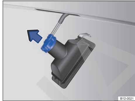
Fig. 122 Luz de la placa de licencia: retirar el portalámparas.
