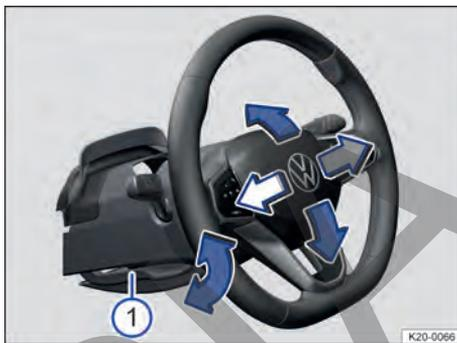
**Fig. 55** Debajo del volante, en el guardacaja de la columna de dirección: palanca para el ajuste manual de la posición del volante.
