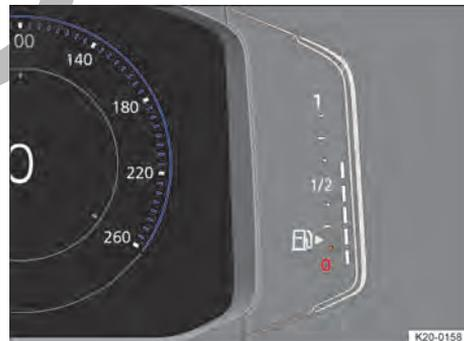
**Fig. 12** Indicador del nivel de combustible en el cuadro de instrumentos digital (variante 1, representación esquemática). <
