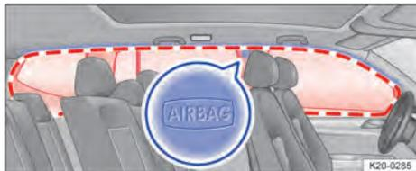
**Fig. 32** En el lado izquierdo del vehículo: ubicación y zona de despliegue del airbag para la cabeza.
