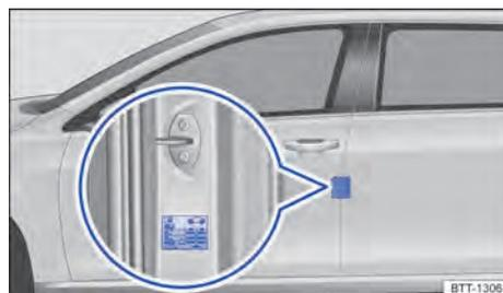
Fig. 159 En el pilar de la puerta del conductor: adhesivo de la presión de los neumáticos (o en la cara interior de la tapa del depósito de combustible).
