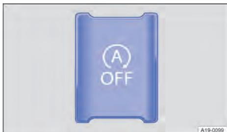
**Fig. 87** En la parte inferior de la consola central o, en función del equipamiento, en el sistema de infotainment: tecla del sistema Start-Stop.
