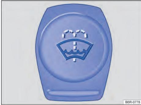
**Fig. 150** En el vano motor: tapa del depósito del líquido lavacristales.
