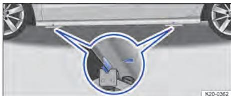
Fig. 169 Puntos de apoyo para el gato.
