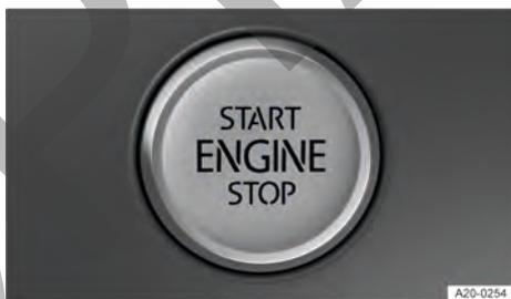
**Fig. 85** En la parte inferior de la consola central: pulsador de encendido y arranque para poner el motor en marcha.
