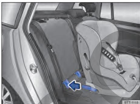
**Fig. 37** Representación esquemática: montaje de un asiento para niños con conectores.
