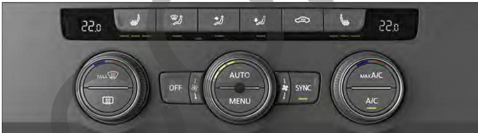
Fig. 81 En la parte superior de la consola central: panel de mandos del Climatronic.
