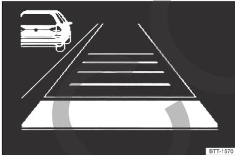
**Fig. 100** En la pantalla del cuadro de instrumentos: vehículo detectado que circula más lentamente que el propio por el carril izquierdo (representación esquemática).
