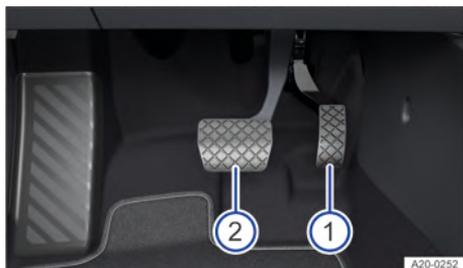
Fig. 82 En la zona reposapiés: pedales.
