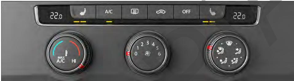
Fig. 80 En la parte superior de la consola central: panel de mandos del climatizador manual.
