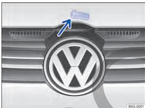
**Fig. 146** Encima de la parrilla del radiador: palanca de accionamiento del capó delantero (representación esquemática).
