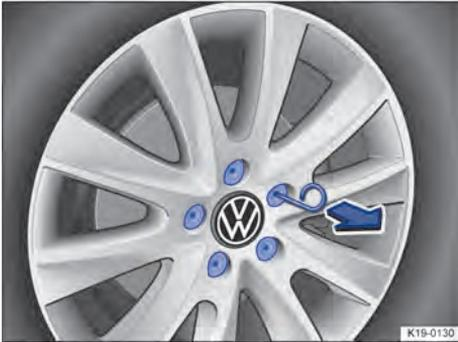
Fig. 165 Retirar las caperuzas de los tornillos de rueda.
