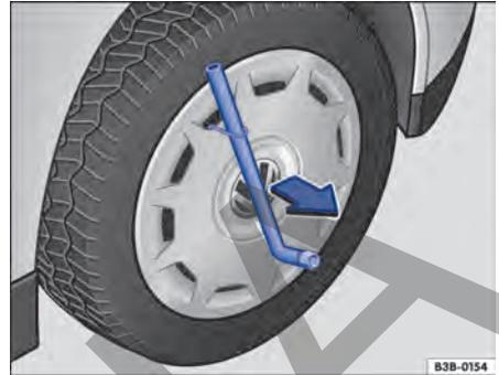
**Fig. 164** Desmontar el tapacubos integral.
