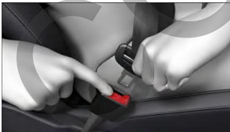
Fig. 22 Soltar la lengüeta del cierre del cinturón.
