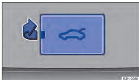
Fig. 51 En el portón del maletero: tapa del desbloqueo de emergencia del portón.
