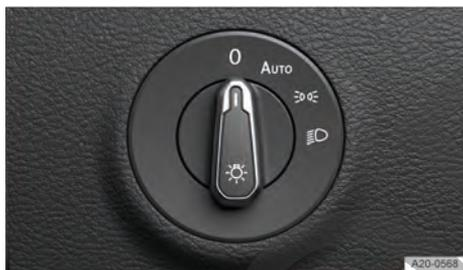
Fig. 69 Junto al volante: mando de las luces.
