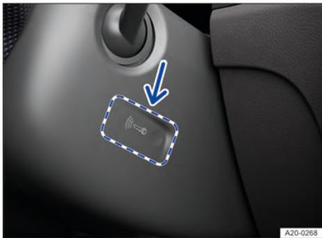
**Fig. 86** En el lado derecho de la columna de dirección: función de arranque de emergencia.
