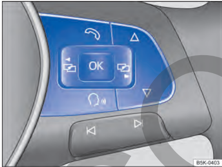
Fig. 19 Lado derecho del volante multifunción: botones para el mando de los menús y visualizaciones de información del instrumento combinado.
