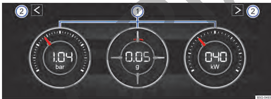
Fig. 20 En la pantalla de la radio: monitor de potencia.
