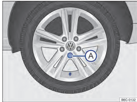
Fig. 221 Cambio de rueda: secuencia de desmontaje de los tornillos de la rueda.
