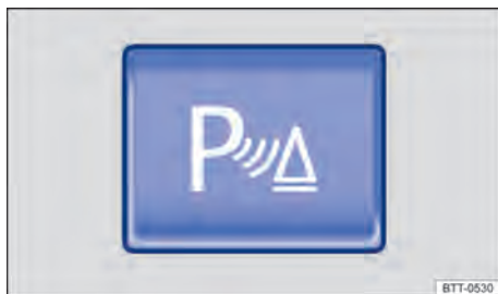
Fig. 101 En la consola central: tecla de encender y apagar la ayuda de estacionamiento (dependiendo de la versión del vehículo).
