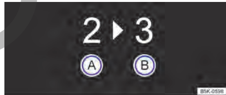
Fig. 86 En el instrumento combinado: indicador de cambio de marcha.
