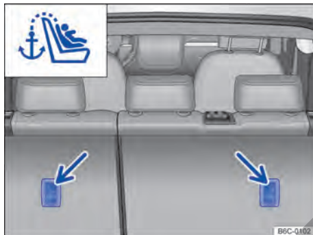
Fig. 45 Ojales de retención para el cinturón de fijación superior en el lado de atrás del asiento trasero.
