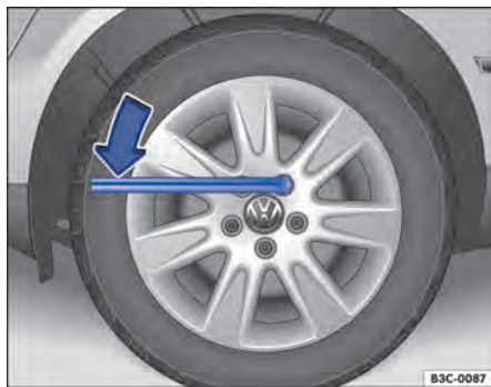
Fig. 217 Cambio de rueda: aflojar los tornillos de la rueda.
