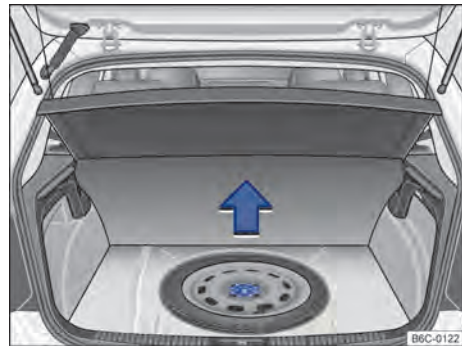
Fig. 174 En el maletero, por debajo del revestimiento del piso: rueda de emergencia y herramientas de a bordo. ▶
