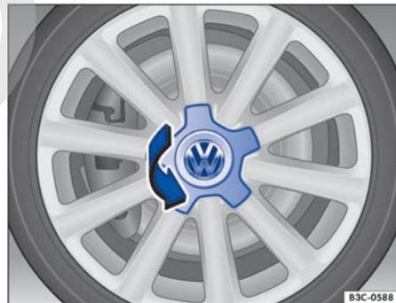
Fig. 209 Desmontar el tapacubos central girándolo.
