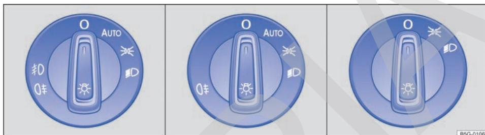
Fig. 86 Junto al volante: representación de algunos tipos de mandos de luces.
