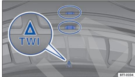
Fig. 205 Perfil del neumático: indicadores de desgaste.
