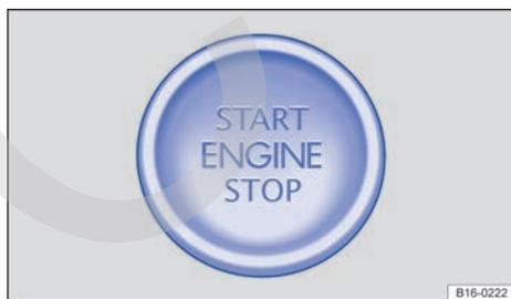
Fig. 112 En la parte inferior de la consola central: pulsador de encendido y arranque del sistema de cierre y arranque Keyless Access.
