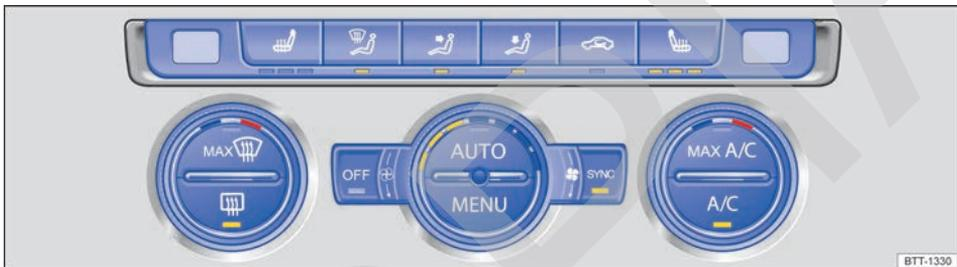
Fig. 104 En la parte superior de la consola central: mandos del Climatronic.
