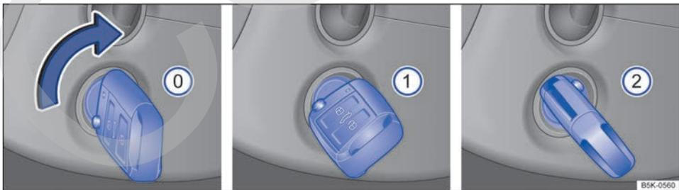
Fig. 111 Posiciones de la llave del vehículo en la cerradura de encendido.
