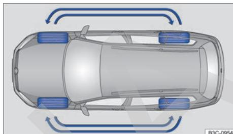
**Fig. 202** Esquema para el intercambio de las ruedas.
