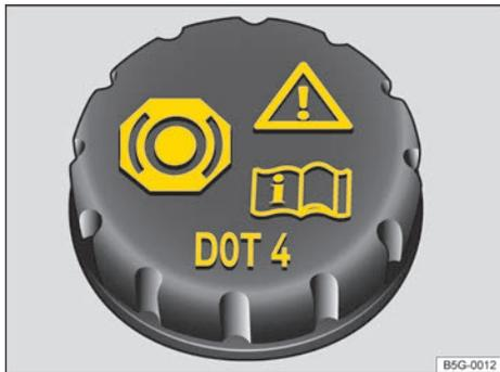
Fig. 194 En el vano motor: tapa del depósito del líquido de frenos (variante 1).
