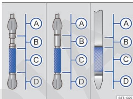
Fig. 196 Varilla de medición con marcas del nivel del aceite del motor.
