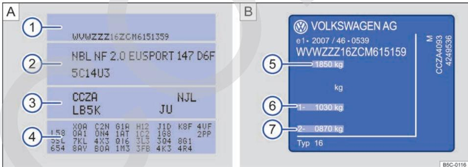
Fig. 223 A Portadatos del vehículo: en la figura, por ejemplo, con letras distintivas del motor CCZA 3. B) Placa de modelo.
