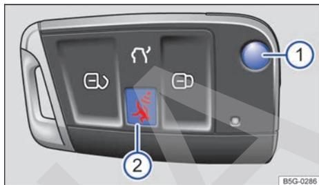
Fig. 48 Llave del vehículo con tecla de alarma.
