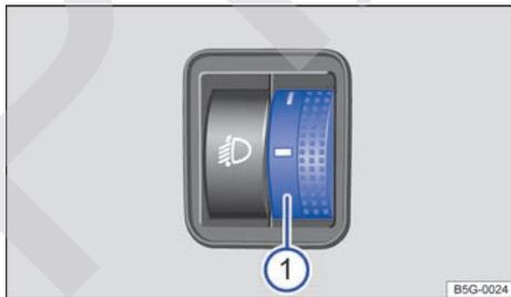
**Fig. 88** Junto al volante: regulador del alcance de las luces .
