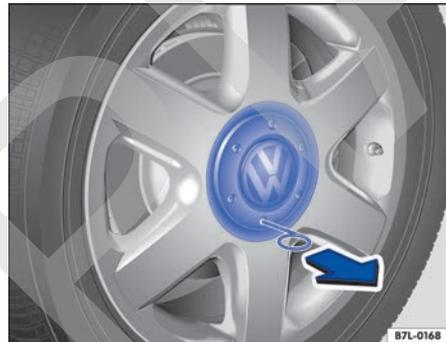
Fig. 208 Desmontar el tapacubos central tirando de él.
