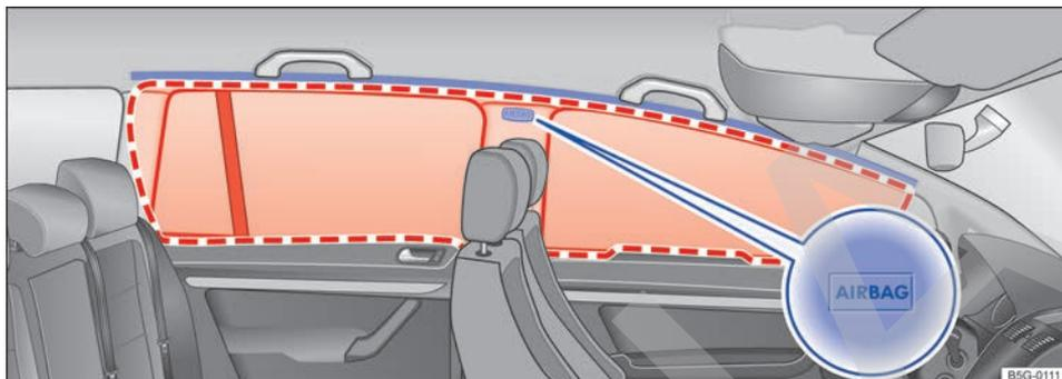
**Fig. 20** En el lado izquierdo del vehículo: ubicación y zona de despliegue del airbag para la cabeza.
