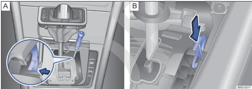
Fig. 72 Debajo de la cubierta de la corredera de la palanca selectora: desbloqueo de emergencia del bloqueo de la palanca selectora (variante A y variante B).
