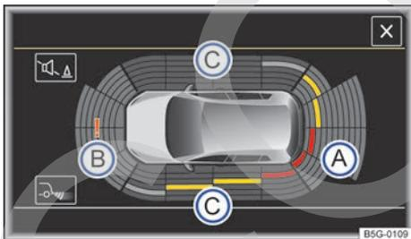
Fig. 128 Visualización periférica del ParkPilot en la pantalla.
