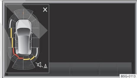
Fig. 129 Visualización periférica reducida en la pantalla.
