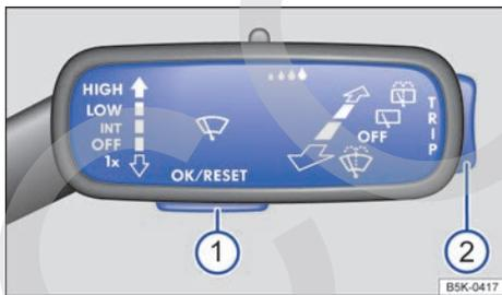
**Fig. 46** Vehículos sin volante multifunción: tecla ① en la palanca del limpiacristales (en el lado derecho de la columna de dirección) para confirmar opciones de menú y tecla basculante ② para cambiar de menú y de indicación informativa.
