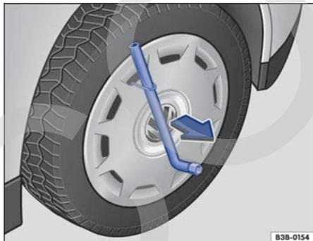
Fig. 210 Desmontar el tapacubos integral.
