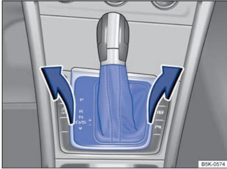
Fig. 71 Desmontar la cubierta de la corredera de la palanca selectora.
