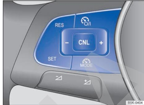
**Fig. 125** Lado izquierdo del volante multifunción: teclas para manejar el limitador de velocidad (en función del equipamiento).
