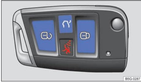
**Fig. 52** Llave del vehículo (en función del equipamiento con tecla de alarma).
