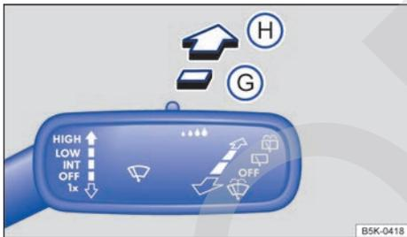
Fig. 91 En el lado derecho de la columna de dirección: manejo del limpialuneta.
