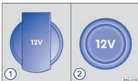
**Fig. 149** Toma de corriente de 12 voltios con tapa plegable (1), toma de corriente de 12 voltios con tapa extraíble (2).
