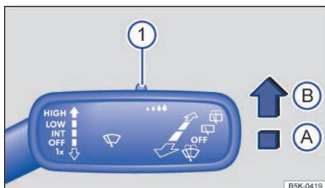
**Fig. 95** En la palanca del limpiacristales, en el lado derecho de la columna de dirección: ajuste del sensor de lluvia y de luz ①.
