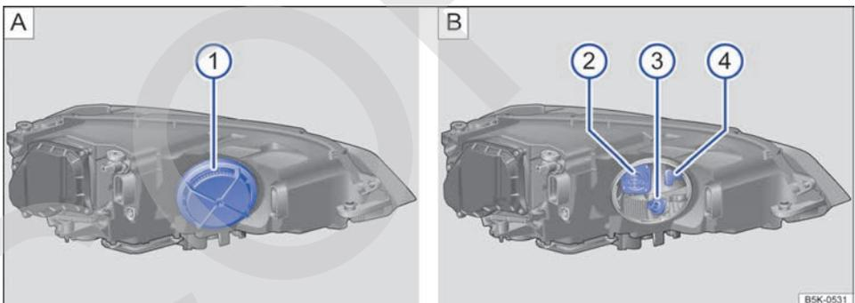
**Fig. 168** En el vano motor: ① tapa en el faro izquierdo, ② luz de curva estática, ③ intermitente, ④ luz de posición y luz diurna independiente.
