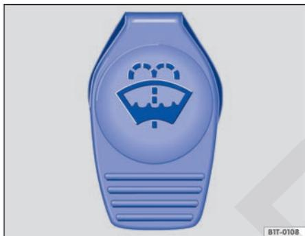
**Fig. 97** En el vano motor: tapa del depósito del lavacristales.
