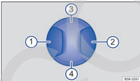
**Fig. 77** Mando en el asiento delantero izquierdo: ajuste del apoyo lumbar.
