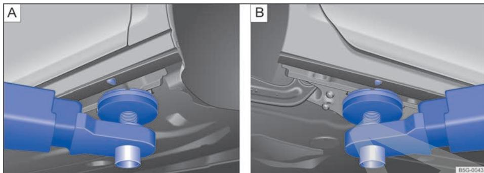
**Fig. 222** **A** Punto de apoyo en la parte delantera y **B** punto de apoyo en la parte trasera para elevar el vehículo con la plataforma elevadora o el gato (variante 2).
