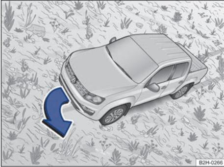
Fig. 145 Girar hacia la línea de caída.
