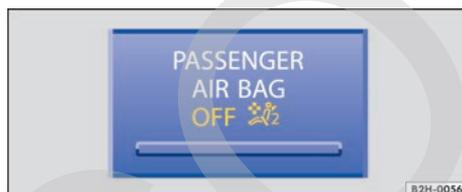
Fig. 65 Testigo de control de la desactivación del airbag frontal del acompañante en el tablero de instrumentos.
