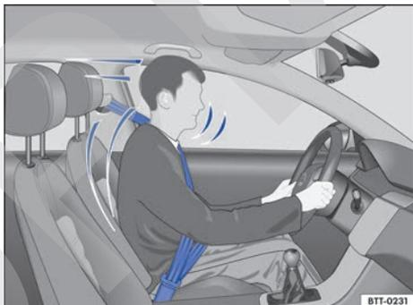
**Fig. 55** Los conductores que lleven el cinturón de seguridad correctamente colocado no saldrán lanzados en caso de un frenazo.
