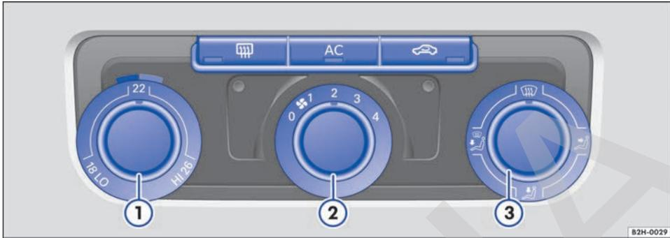
Fig. 127 En el tablero de instrumentos: mandos del Climatic.
