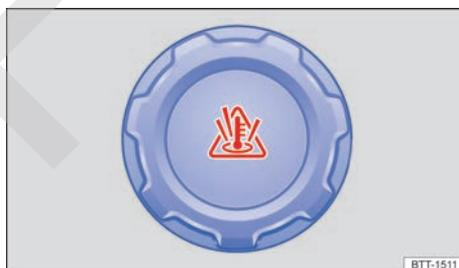
Fig. 153 En el compartimento del motor: tapa del depósito de expansión del líquido refrigerante.
