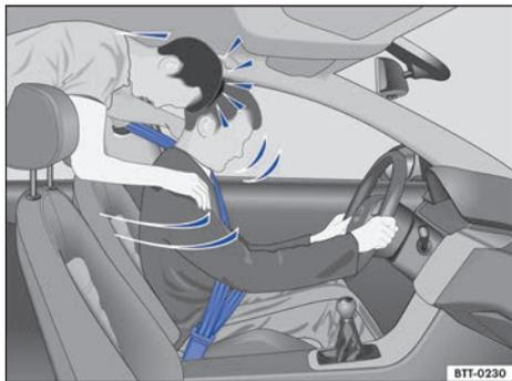
**Fig. 54** El ocupante del asiento trasero sin el cinturón de seguridad colocado sale lanzado hacia delante topando contra el conductor, que sí lo lleva colocado.
