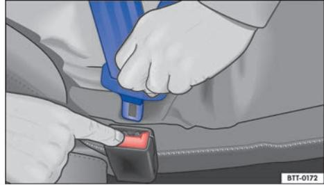
**Fig. 57** Soltar la lengüeta del cierre del cinturón.
