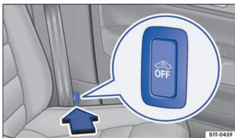
**Fig. 21** Junto al asiento del conductor, en el pilar B: tecla para desconectar la vigilancia del habitáculo y el sistema antirremolcado.
