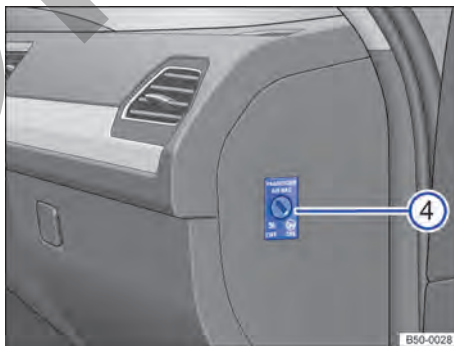
Fig. 11 Con la puerta del acompañante abierta (vehículos con el volante a la izquierda): conmutador de llave en el tablero de instrumentos (disposición simétrica en los vehículos con el volante a la derecha).
