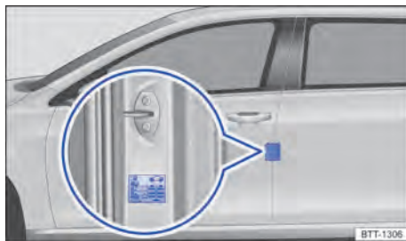
Fig. 247 En el pilar de la puerta del conductor: adhesivo de la presión de los neumáticos (o en la cara interior de la tapa del depósito de combustible).
