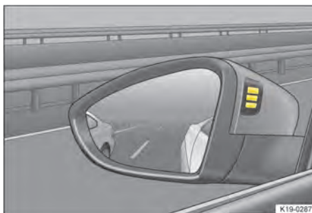
Fig. 159 En las carcasas de los retrovisores exteriores: indicaciones ópticas del asistente de cambio de carril.
