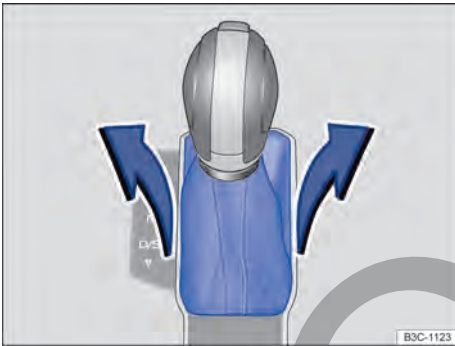
Fig. 137 Desmontar la cubierta de la corredera de la palanca selectora.
