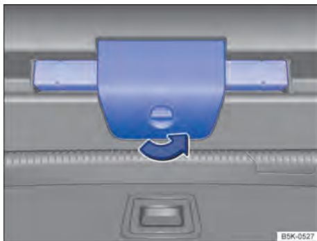
Fig. 60 En el portón del maletero: soporte del triángulo de preseñalización.
