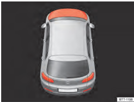
Fig. 235 En la pantalla del cuadro de instrumentos: capó delantero abierto o no cerrado correctamente (representación esquemática).
