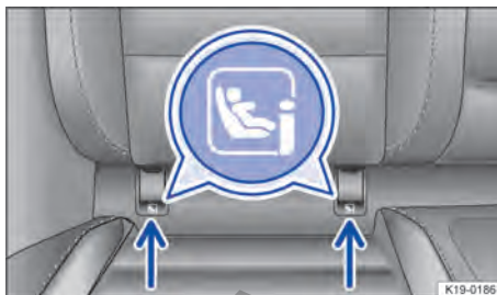
Fig. 57 Señalización de los puntos de anclaje i-Size para los asientos para niños.
