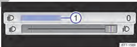
Fig. 113 En el sistema de infotainment: regulador táctil para la regulación del alcance de las luces.
