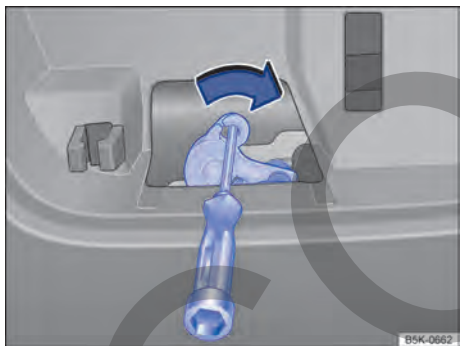
Fig. 82 En el portón del maletero: desbloqueo de emergencia del portón.
