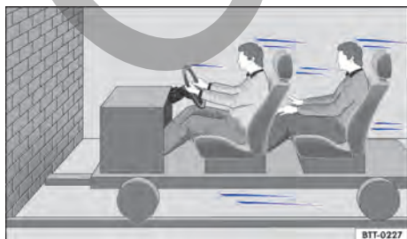
Fig. 31 Vehículo a punto de chocar contra un muro. Los ocupantes no llevan colocado el cinturón de seguridad.
