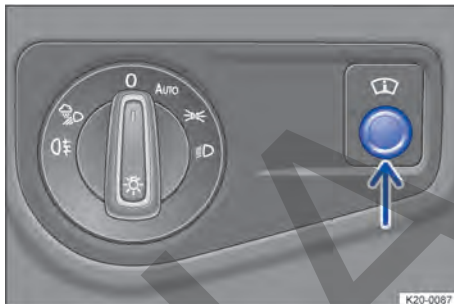
Fig. 18 Junto al volante: regulador del Head-up-Display (flecha).
