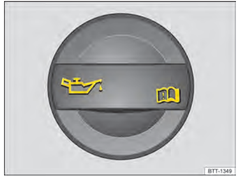
Fig. 238 En el vano motor: tapa de la boca de llenado de aceite del motor (representación esquemática).
