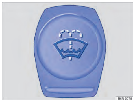
Fig. 236 En el vano motor: tapa del depósito del líquido lavacrystales.
