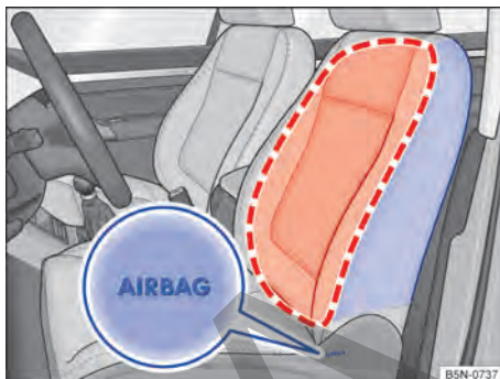
Fig. 47 Lateral de un asiento delantero: ubicación y zona de despliegue del airbag lateral.
