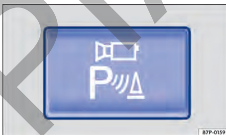
Fig. 170 En la consola central: tecla para conectar y desconectar el sistema de visión periférica (representación esquemática).
