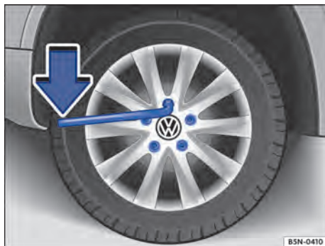
Fig. 253 Cambio de rueda: aflojar los tornillos de rueda.
