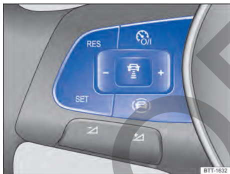
Fig. 155 Lado izquierdo del volante multifunción: teclas para manejar el ACC.
