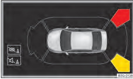
Fig. 175 En la pantalla del sistema de infotainment: visualización del asistente de salida del aparcamiento.
