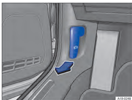
Fig. 233 En la zona reposapiés del lado del conductor: palanca de desbloqueo del capó delantero (representación esquemática).
