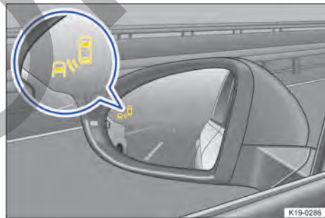
Fig. 158 En el retrovisor exterior: indicación del detector de ángulo muerto.
