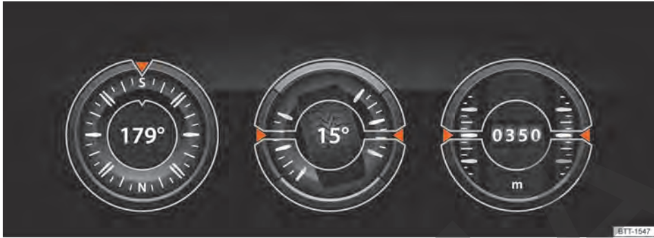
Fig. 141 En el sistema de infotainment: indicador Offroad.
