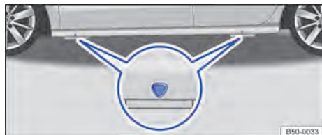
Fig. 258 Puntos de apoyo para el gato.
