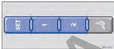
Fig. 102 En el lateral exterior del asiento del conductor: teclas de memoria.
