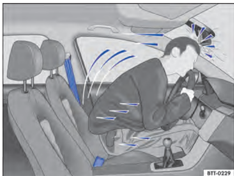
Fig. 33 El conductor sin el cinturón de seguridad colocado sale lanzado hacia delante.
