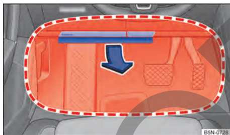
Fig. 51 En el lado del conductor: zona de despliegue del airbag para las rodillas.
