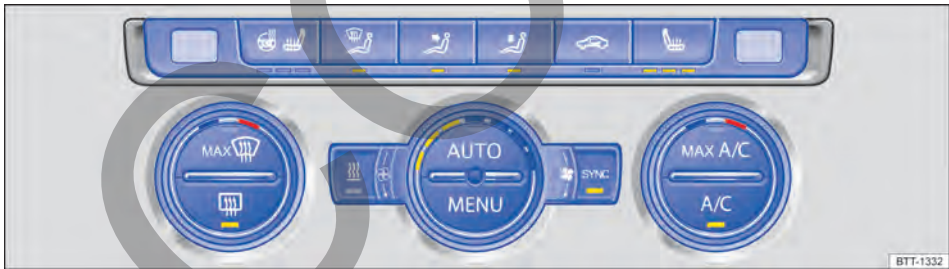
Fig. 123 En la parte superior de la consola central: panel de mandos del Climatronic.
