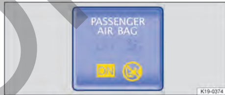
Fig. 42 En la consola central: testigo de control de la activación del airbag frontal del acompañante.
