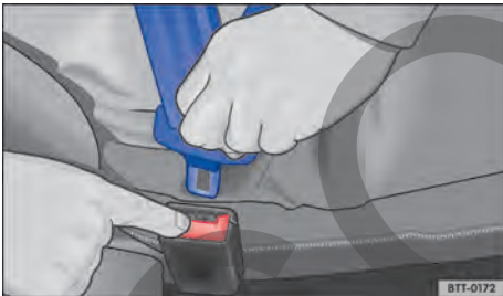
Fig. 37 Soltar la lengüeta del cierre del cinturón.
