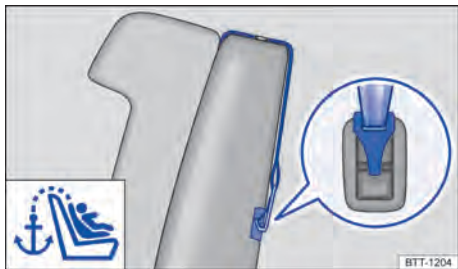
Fig. 59 En la parte posterior de la segunda fila de asientos: argollas de sujeción para el cinturón de fijación superior.
