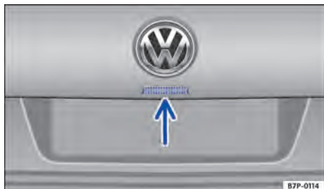
Fig. 76 En el portón del maletero: pulsador para abrir el portón.
