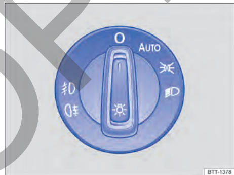
Fig. 109 Junto al volante: mando de las luces (una variante).
