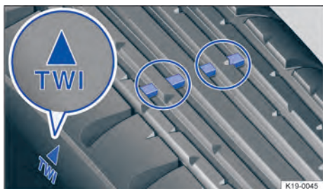
Fig. 248 Perfil del neumático: indicadores de desgaste.
