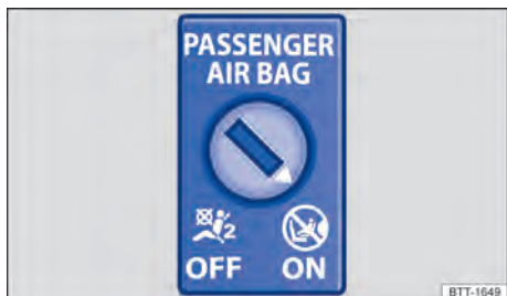
Fig. 45 En el tablero de instrumentos, en el lado del acompañante: conmutador de llave para desactivar y activar el airbag frontal del acompañante.
