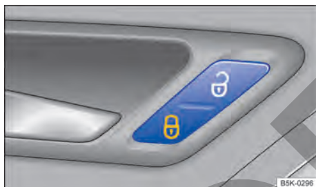
Fig. 70 En la puerta del conductor: tecla del cierre centralizado.
