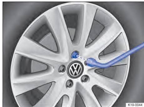
Fig. 261 Cambio de rueda: desenroscar los tornillos de rueda con la llave de rueda.
