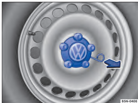
Fig. 250 Desmontar el tapacubos central tirando de él.
