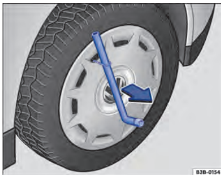
Fig. 251 Desmontar el tapacubos integral.
