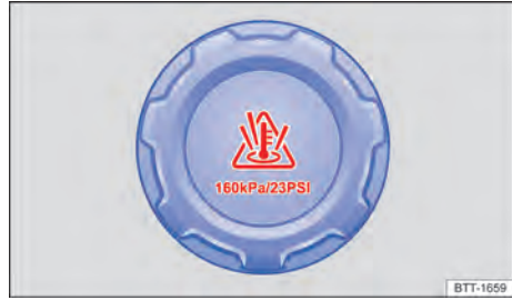
Fig. 240 En el vano motor: tapa del depósito de expansión del líquido refrigerante del motor (representación esquemática).
