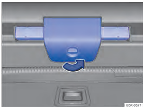
Fig. 81 En el portón del maletero: abrir el soporte del triángulo de preseñalización.
