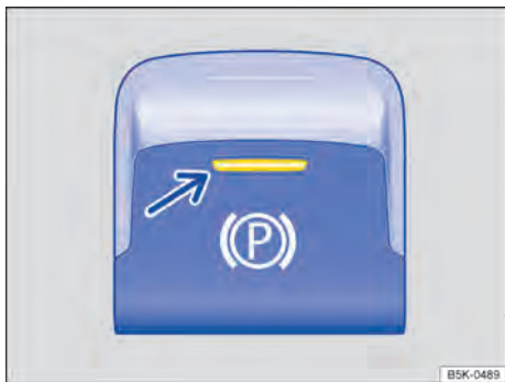
Fig. 160 En la consola central: tecla del freno de estacionamiento electrónico (representación esquemática).
