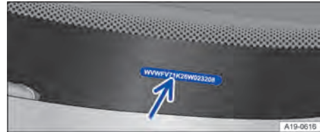
Fig. 268 En el parabrisas: número de identificación del vehículo.
