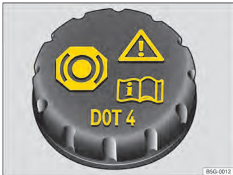
Fig. 241 En el vano motor: tapa del depósito del líquido de frenos.
