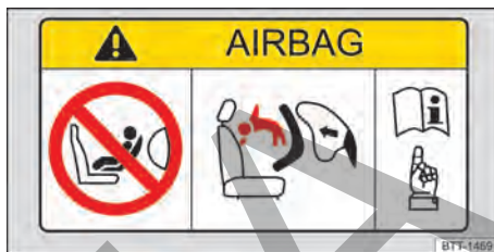
Fig. 53 Representación esquemática: etiqueta adhesiva relativa al airbag en el parasol.
