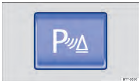
Fig. 163 En la consola central: tecla para conectar y desconectar la ayuda de aparcamiento (representación esquemática).
