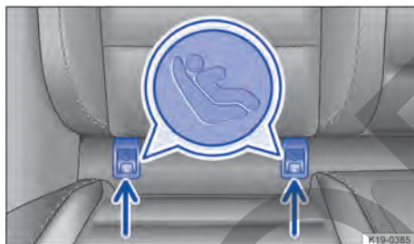
Fig. 55 Señalización de los puntos de anclaje ISOFIX para los asientos para niños.
