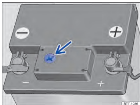
Fig. 209 En el compartimento del motor: ejemplo de posición del visor en el lado superior de la batería del vehículo.
