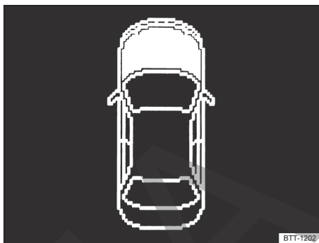
Fig. 202 En el display del instrumento combinado: tapa del compartimento del motor abierta o cerrada incorrectamente (representación esquemática).
