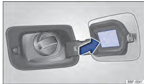
Fig. 213 En la parte interior de la portezuela del depósito de combustible: etiqueta con la presión de los neumáticos.
