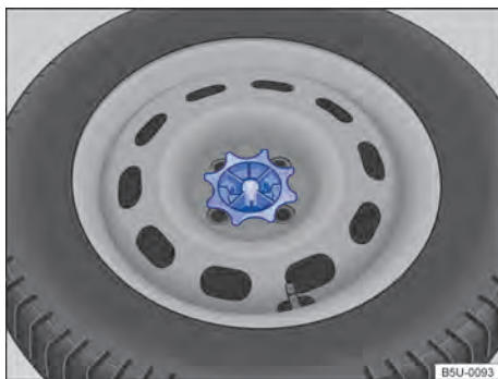
Fig. 215 En el maletero: manivela para fijación de la rueda de emergencia.
