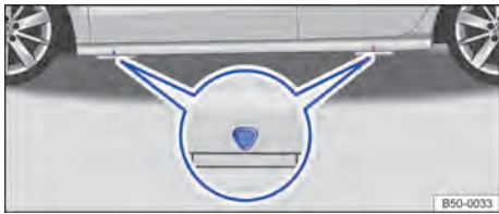
Fig. 219 Puntos de apoyo del gato.
