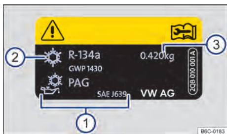
Fig. 227 Información del aire acondicionado
