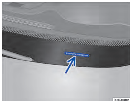
Fig. 226 En el parabrisas: número de identificación del vehículo.
