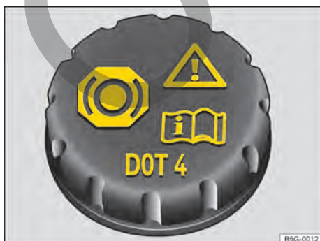
Fig. 208 En el compartimento del motor: tapón de cierre del depósito del líquido de frenos.
