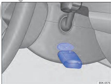
Fig. 93 A la derecha en la columna de dirección: función de arranque de emergencia en vehículos con sistema de bloqueo y de arranque Keyless Access sin llave.
