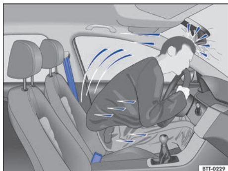
Fig. 46 El conductor sin cinturón de seguridad es lanzado hacia adelante.
