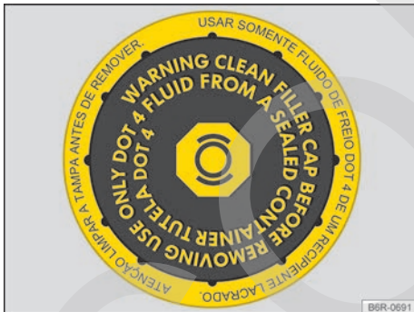
Fig. 111 En el compartimento del motor: tapa del depósito del líquido de freno.
