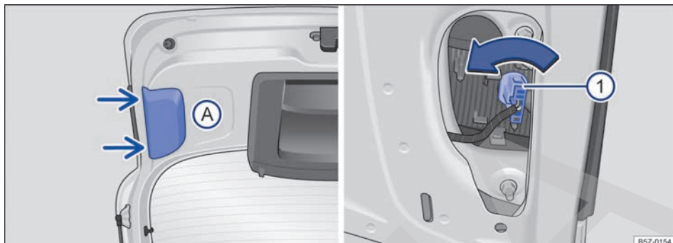
Fig. 179 En la tapa del maletero: desmonte la cubierta de la lámpara de la linterna trasera derecha y/o la linterna trasera izquierda - para vehículos sin linterna de neblina.
