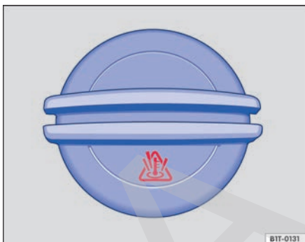
Fig. 133 En el compartimento del motor: tapón del depósito de expansión del líquido refrigerante de motor.
