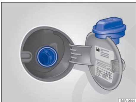
Fig. 126 Puerta del depósito de combustible abierta con la tapa del depósito de combustible colgada.
