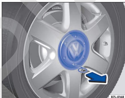
Fig. 194 Desmontar el tapacubos central tirando de él.
