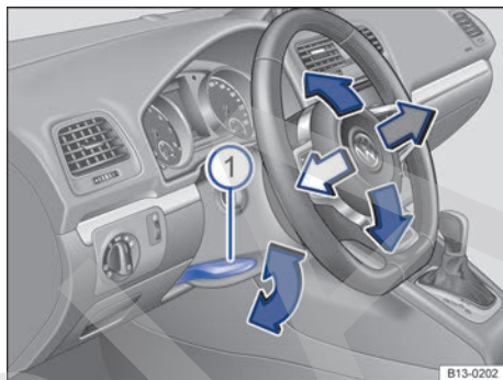
Fig. 69 Debajo del volante, en el guarnecido de la columna de dirección: palanca para el ajuste manual de la posición del volante.
