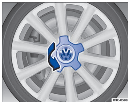
Fig. 195 Desmontar el tapacubos central girándolo.
