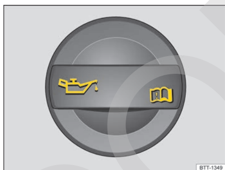
Fig. 181 En el vano motor: tapa de la boca de llenado de aceite del motor (representación esquemática).
