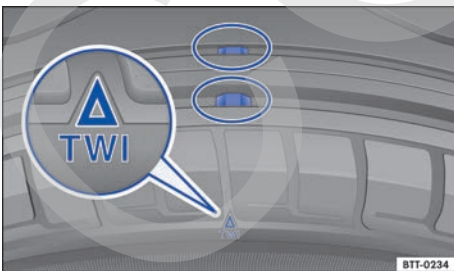
Fig. 191 Perfil del neumático: indicadores de desgaste.
