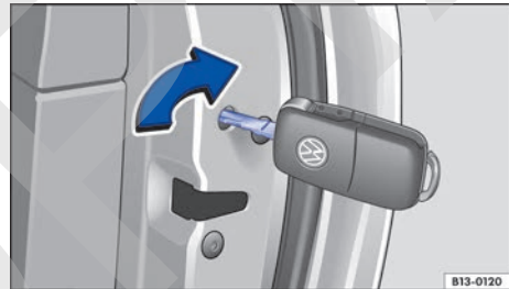
Fig. 59 En el frontal de la puerta del acompañante: bloqueo de emergencia de la puerta del acompañante con la llave del vehículo.
