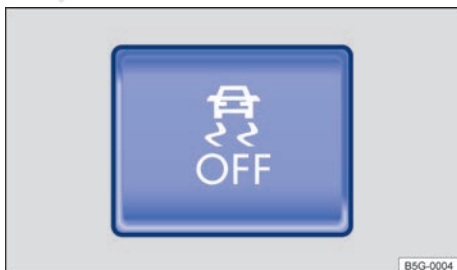
Fig. 131 En la consola central: tecla para desconectar y conectar manualmente el ASR, el ASR junto con el ESC, o el ESC Sport.
