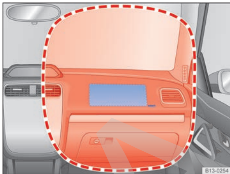
Fig. 14 Ubicación y zona de despliegue del airbag frontal del acompañante.
