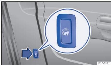
Fig. 53 Junto al asiento del conductor: tecla para desconectar la vigilancia del habitáculo y el sistema antirremolcado.
