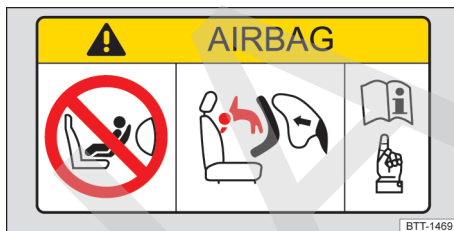
Fig. 20 Representación esquemática: etiqueta adhesiva relativa al airbag en el parasol.
