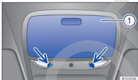
Fig. 54 En la consola del techo: sensores de la vigilancia del habitáculo (flechas).
