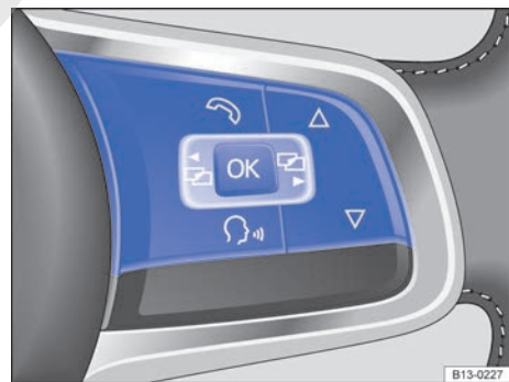
Fig. 46 Lado derecho del volante multifunción: teclas para utilizar los menús y las indicaciones informativas del cuadro de instrumentos.
