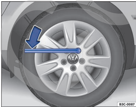
Fig. 198 Cambio de rueda: aflojar los tornillos de rueda.
