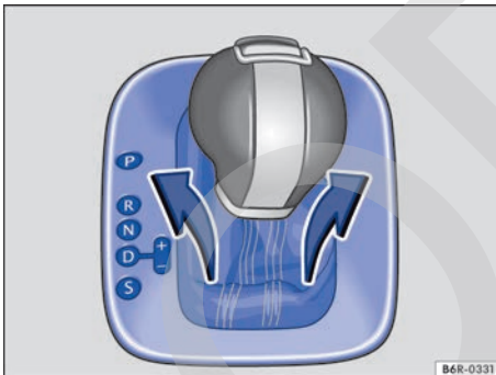
Fig. 108 Desmontar la cubierta de la corredera de la palanca selectora.
