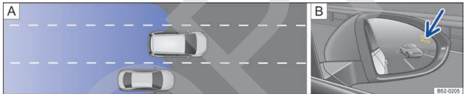
Fig. 115 Representación esquemática: A Situación en un adelantamiento e incorporación posterior al carril derecho. B Indicación del detector de ángulo muerto en el retrovisor exterior derecho.
