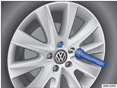
Fig. 276 Cambio de rueda: desenroscar los tornillos de rueda con el mango del destornillador.
