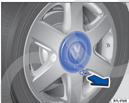
Fig. 267 Desmontar el tapacubos central tirando de él.
