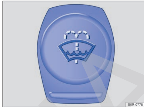
Fig. 252 En el vano motor: tapa del depósito del líquido lavacrystalales.
