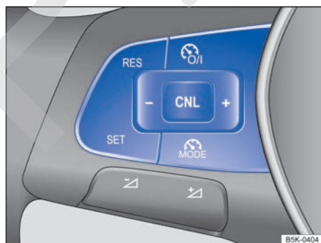
Fig. 146 Lado izquierdo del volante multifunción: teclas para manejar el GRA.
