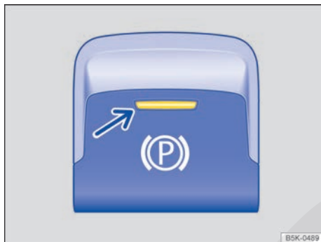
Fig. 156 En la consola central: tecla del freno de estacionamiento electrónico.
