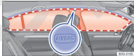
Fig. 52 En el lado izquierdo del vehículo (berlina): ubicación y zona de despliegue del airbag para la cabeza.
