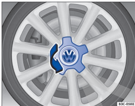
Fig. 268 Desmontar el tapacubos central girándolo.
