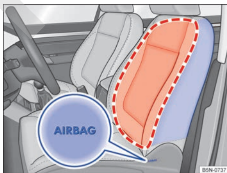
Fig. 51 Lateral de un asiento delantero: ubicación y zona de despliegue del airbag lateral.
