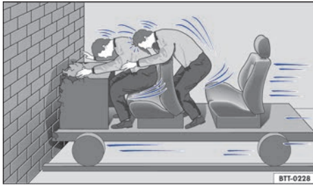
Fig. 37 El vehículo choca contra el muro. Los ocupantes no llevan colocado el cinturón de seguridad.
