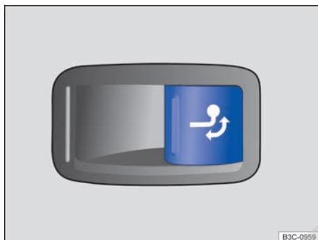
Fig. 217 En el lado derecho del maletero: tecla para desbloquear el enganche de bola.
