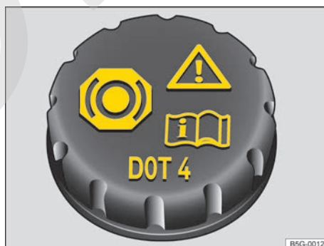
Fig. 257 En el vano motor: tapa del depósito del líquido de frenos.
