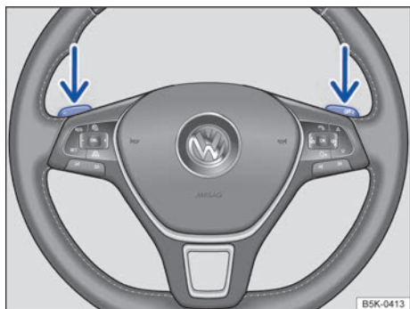
Fig. 138 Volante con levas de cambio para el Tiptronic.
