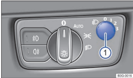
Fig. 109 Junto al volante: regulador del alcance de las luces ①.
