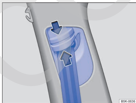
Fig. 45 Junto a los asientos delanteros: regulador de la altura del cinturón.
