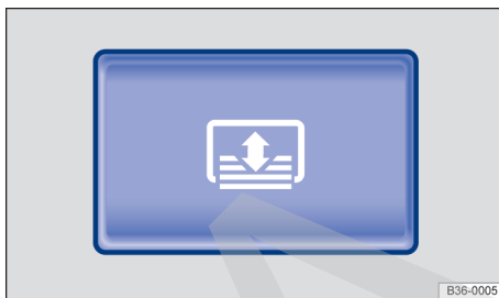
Fig. 120 En la consola central: tecla para la cortinilla eléctrica de la luneta.
