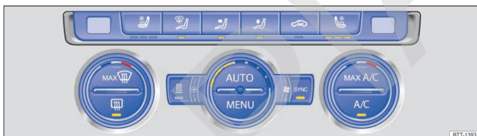
Fig. 122 En la parte superior de la consola central: panel de mandos del Climatronic.
