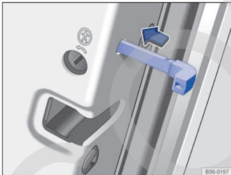
Fig. 78 En el frontal de la puerta trasera derecha: bloqueo de emergencia del vehículo con la llave de emergencia.
