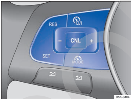
Fig. 148 Lado izquierdo del volante multifunción: teclas para manejar el limitador de velocidad.
