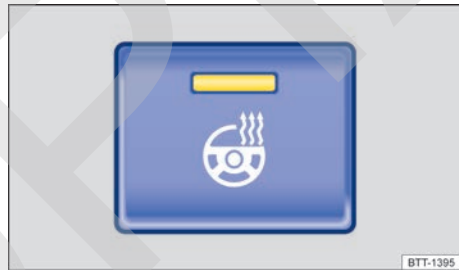
Fig. 124 En la parte inferior de la consola central: tecla para la calefacción del volante.
