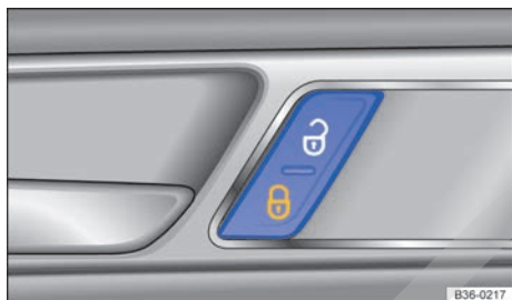
Fig. 76 En la puerta del conductor: tecla del cierre centralizado.
