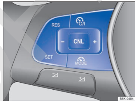
Fig. 157 Lado izquierdo del volante multifunción: teclas para manejar el limitador de velocidad. ▶
