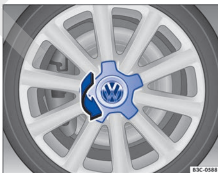
Fig. 209 Desenroscar el tapacubos central.
