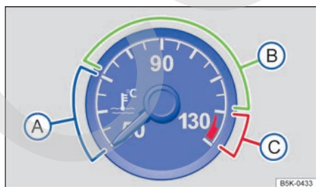
Fig. 180 Indicador de la temperatura del líquido refrigerante del motor: (A) zona fría; (B) zona normal; (C) zona de advertencia.
