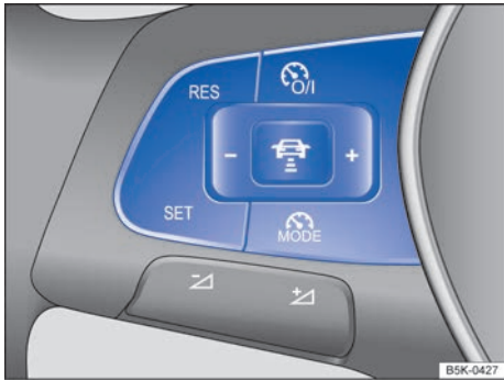
Fig. 162 Lado izquierdo del volante multifunción: teclas para manejar el control de crucero adaptativo.
