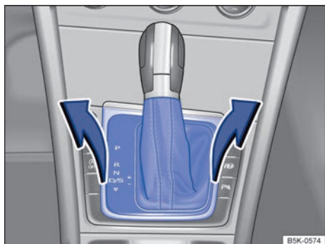
Fig. 203 Desmontar la cubierta de la corredera de la palanca selectora.
