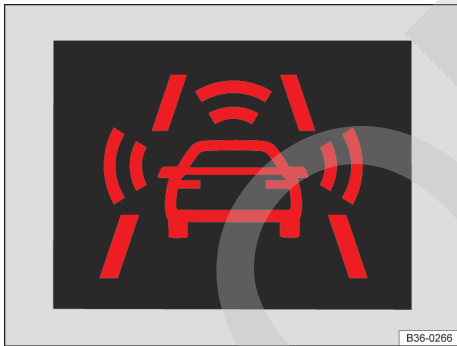
Fig. 169 En la pantalla del cuadro de instrumentos: indicación del preaviso.
