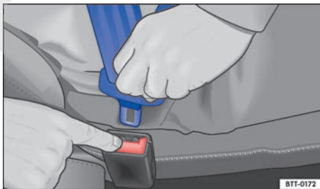
Fig. 65 Soltar la lengüeta del cierre del cinturón.
