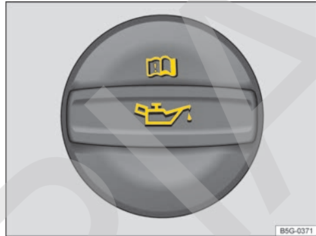
Fig. 179 En el vano motor: tapa de la boca de llenado de aceite.
