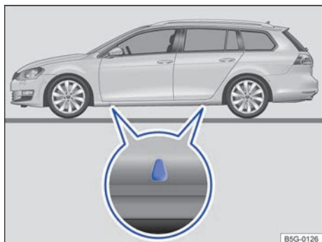
Fig. 214 Puntos de apoyo para el gato.
