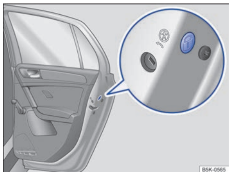
Fig. 199 En el frontal de la puerta trasera derecha: bloqueo de emergencia cubierto por una junta de goma.
