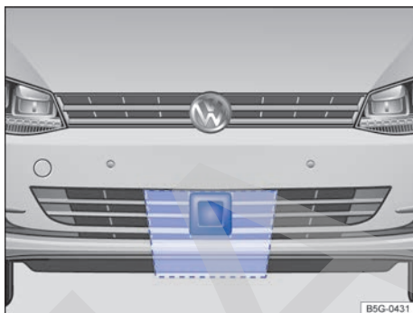
Fig. 161 Zona que hay que dejar libre alrededor del sensor de radar.
