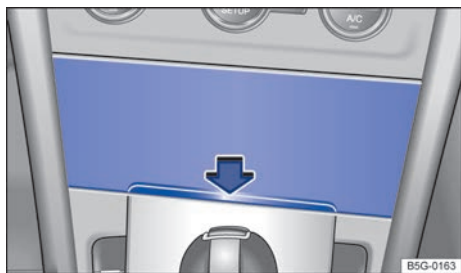
Fig. 112 En la parte inferior de la consola central: portaobjetos.
