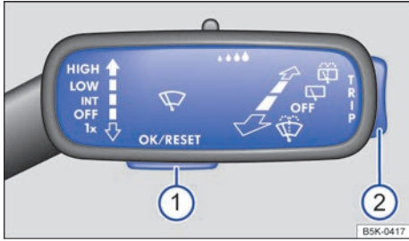
Fig. 14 Vehículos sin volante multifunción: tecla ① en la palanca del limpiacristales (en el lado derecho de la columna de dirección) para confirmar opciones de menú y tecla basculante ② para cambiar de menú y de indicación informativa.
