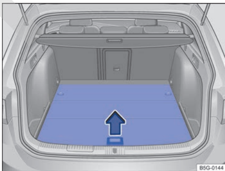
Fig. 206 En el maletero: abrir el piso del maletero.
