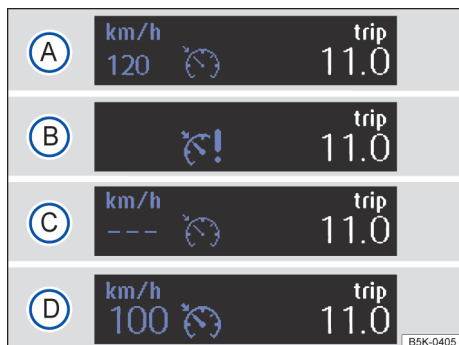
Fig. 152 En la pantalla del cuadro de instrumentos: indicaciones del estado del GRA.
