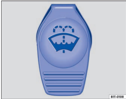
Fig. 91 En el vano motor: tapa del depósito del lavacristales.
