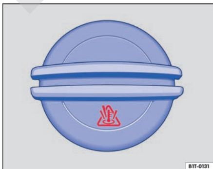
Fig. 182 En el vano motor: tapa del depósito de expansión del líquido refrigerante del motor.
