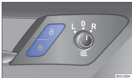
Fig. 30 En la puerta del conductor: tecla del cierre centralizado.
