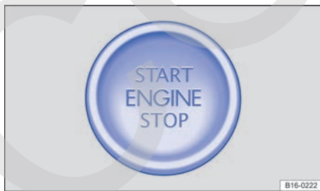
Fig. 125 En la parte inferior de la consola central: pulsador de arranque del sistema de cierre y arranque Keyless Access.
