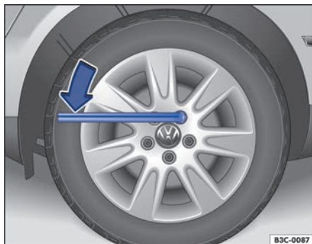
Fig. 212 Cambio de rueda: aflojar los tornillos de rueda.
