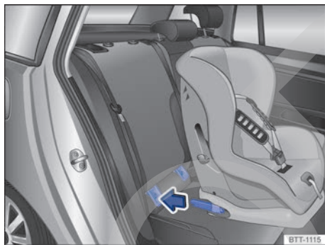
Fig. 79 Representación esquemática: montaje de un asiento para niños ISOFIX con conectores.
