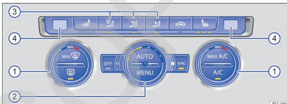
Fig. 172 En la parte superior de la consola central: mandos del Climatronic.
