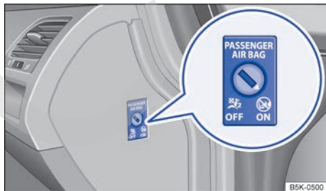
Fig. 72 En el tablero de instrumentos del lado del acompañante: interruptor de llave para activar y desactivar el airbag frontal del acompañante.
