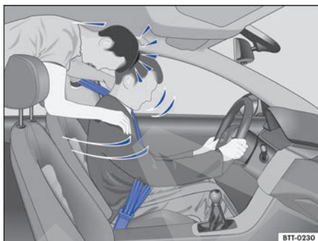
Fig. 62 El ocupante del asiento trasero sin el cinturón de seguridad colocado sale lanzado hacia delante topando contra el conductor, que sí lo lleva colocado.
