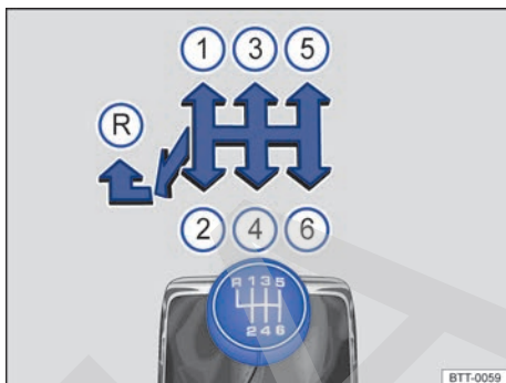
Fig. 130 Esquema de un cambio manual de 6 marchas.
