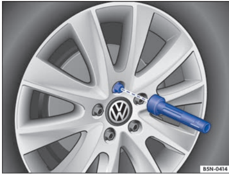
Fig. 218 Cambio de rueda: desenroscar los tornillos de rueda con el mango del destornillador.
