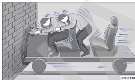
Fig. 60 El vehículo choca contra el muro. Los ocupantes no llevan colocado el cinturón de seguridad.
