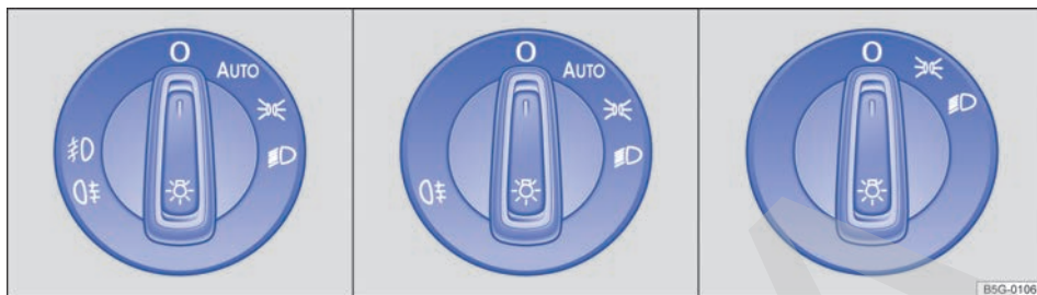
Fig. 82 Junto al volante: representación de algunos tipos de mandos de luces.
