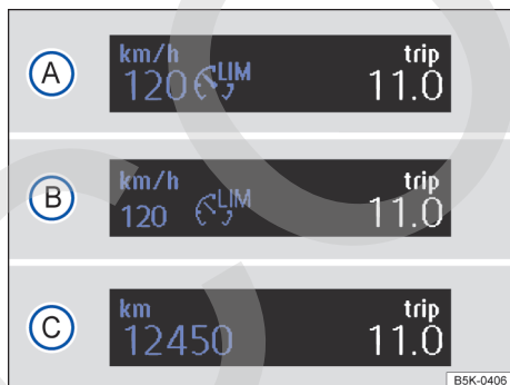
Fig. 155 En la pantalla del cuadro de instrumentos: indicaciones del estado del limitador de velocidad.
