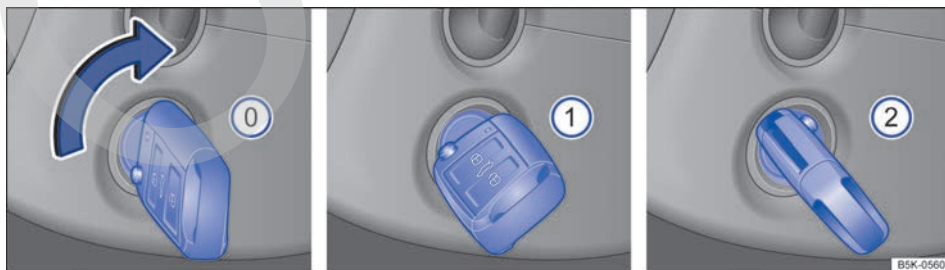
Fig. 124 Posiciones de la llave del vehículo en la cerradura de encendido.
