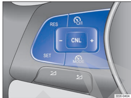
Fig. 154 Lado izquierdo del volante multifunción: teclas para manejar el GRA.
