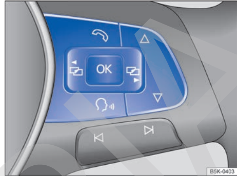
Fig. 15 Lado derecho del volante multifunción: teclas para utilizar los menús y las indicaciones informativas del cuadro de instrumentos.
