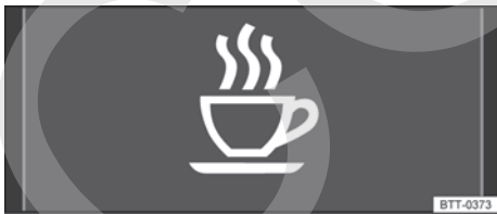
Fig. 170 En la pantalla del cuadro de instrumentos: símbolo de detección del cansancio.
