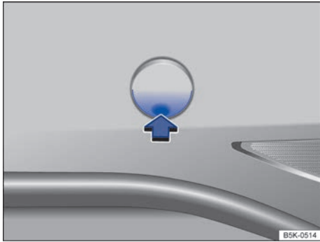
Fig. 235 En el lado derecho del paragolpes trasero: retirar la tapa.
