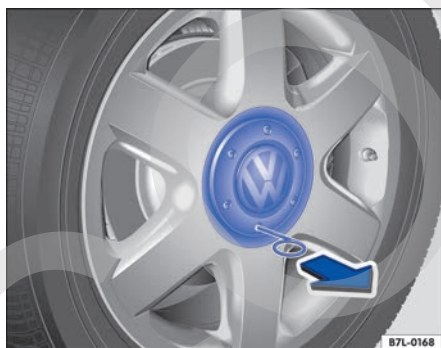
Fig. 208 Desmontar el tapacubos central.
