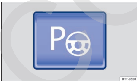
Fig. 148 En la parte inferior de la consola central: tecla para conectar el sistema de aparcamiento asistido.
